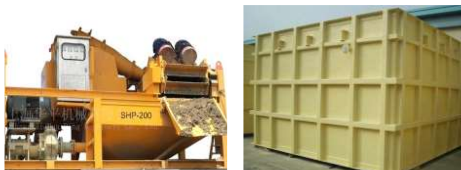
图 6.2-3 泥浆净化装置和钢制泥浆池
